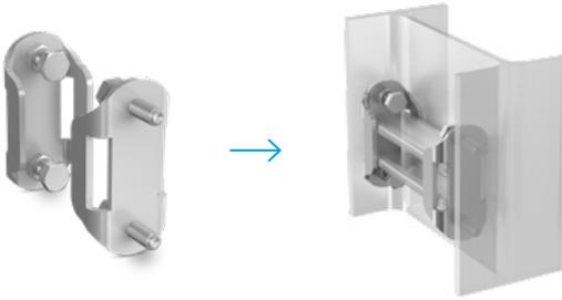
**Anwendung:** für den Einsatz mit dem Profil MF; Montage im Inneren des U-Profils oder des Doppel-T-Profils mit 4 Spreizschrauben; nach dem Nachziehen sind die Schrauben zusätzlich mit einer Mutter zu kontern; die Länge des Profils MF muss gem. der Innenabmessung des Trägers zugeschnitten werden.
