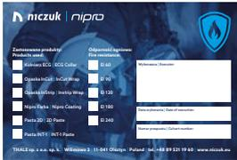
**Anwendung:** Hinweischild mit Informationen über den Abschluss der Brandschutzvorrichtungen, über Feuerbeständigkeitsklasse der Überführungen der Leitungen in den Brandschutz-Trennelementen
